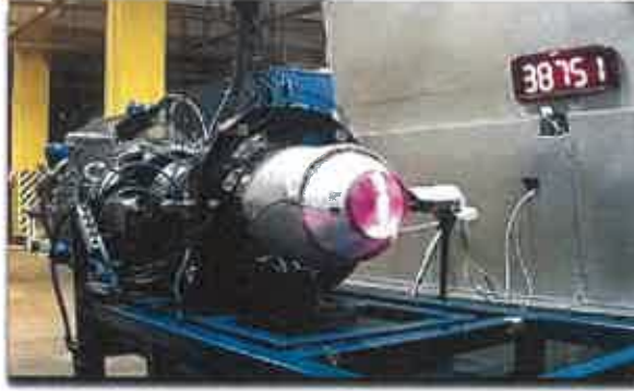
Şekil 11: KTJ-3200 Mukavemet Testlerinden Görünüm
